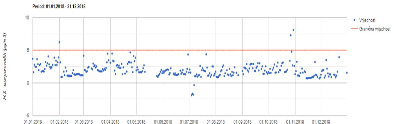
**Slika 10.** Grafički prikaz dnevnih rezultata koncentracija sumporovodika u 2018. godini na mjernoj postaji Urinj
