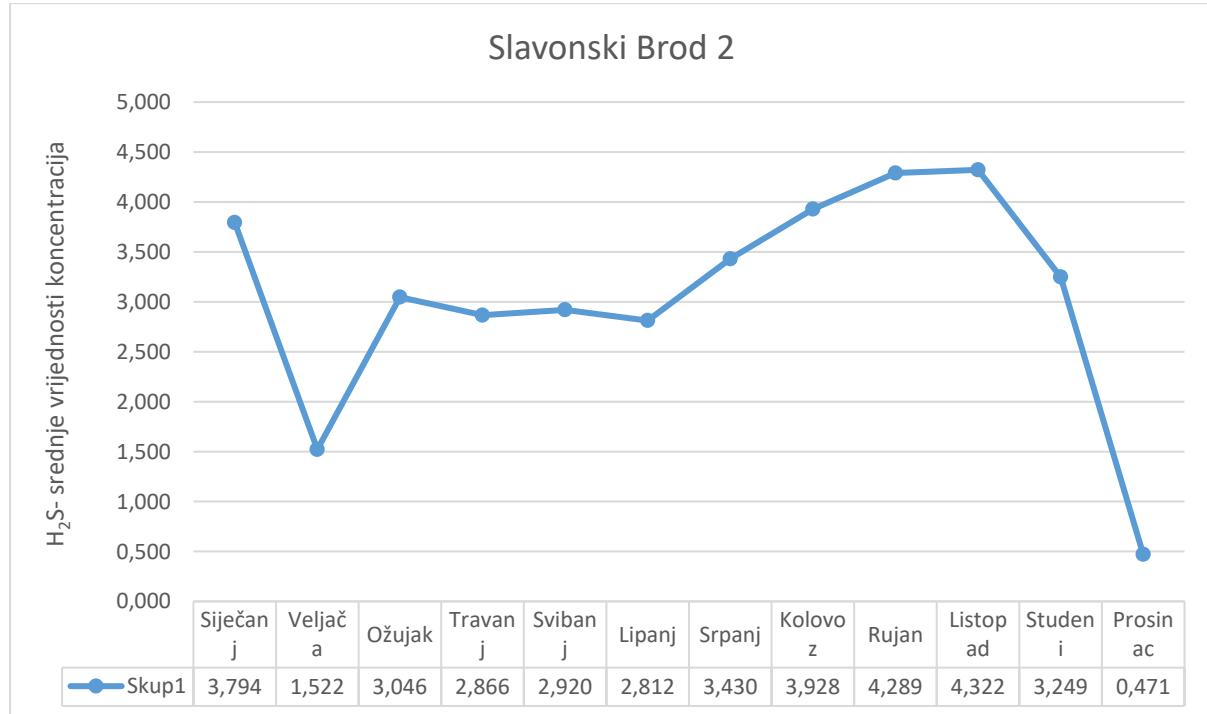
**Slika 11.** Grafički prikaz srednjih vrijednosti sumporovodika za 2018. godinu na mjernoj postaji Slavonski Brod 2
