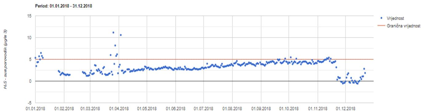
**Slika 12.** Grafički prikaz dnevnih rezultata koncentracija sumporovodika sumporovodika u 2018. godini na mjernoj postaji Slavonski Brod 2
