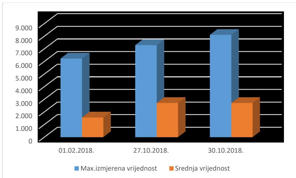
**Slika 14.** Usporedba maksimalnih izmjerenih koncentracija i srednjih vrijednosti sumporovodika na datume kada su izmjerene koncentracije koje prekoračuju granične vrijednosti na mjernoj postaji Urinj
