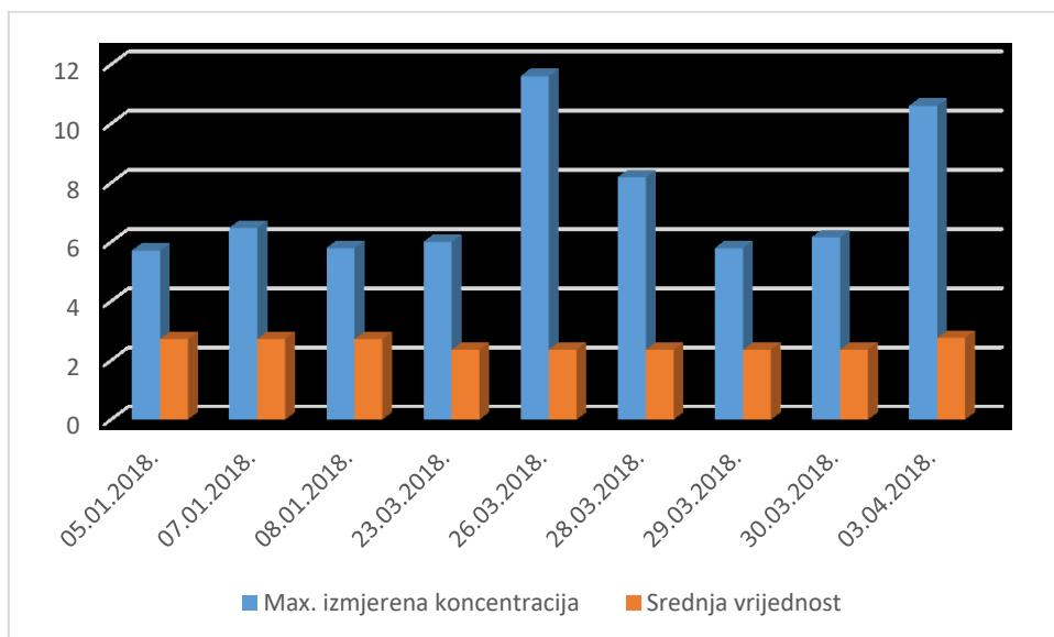
**Slika 15.** Usporedba maksimalnih izmjerenih koncentracija i srednjih vrijednosti sumporovodika na datume kada su izmjerene koncentracije koje prekoračuju granične vrijednosti na mjernoj postaji Slavonski Brod 2
