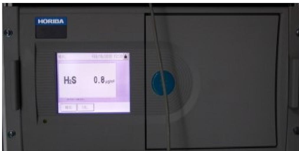
**Slika 8.** Automatski analizator Horiba APSA-H370
