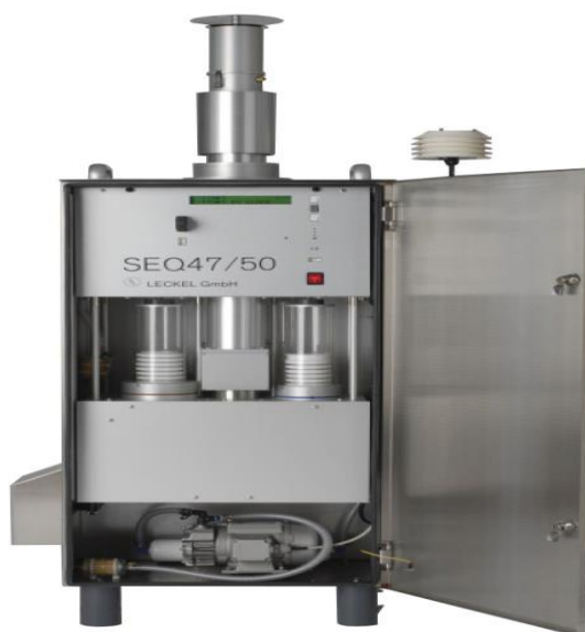
Slika 13. Uređaj na principu standardne gravimetrijske metode, SEQ 47/50 Sven Leckel
