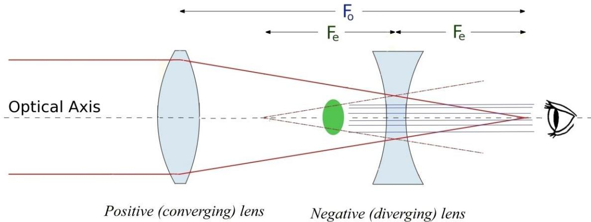
Slika 7. Princip rada lupa – Galilejski tip. Preuzeto iz 2.
