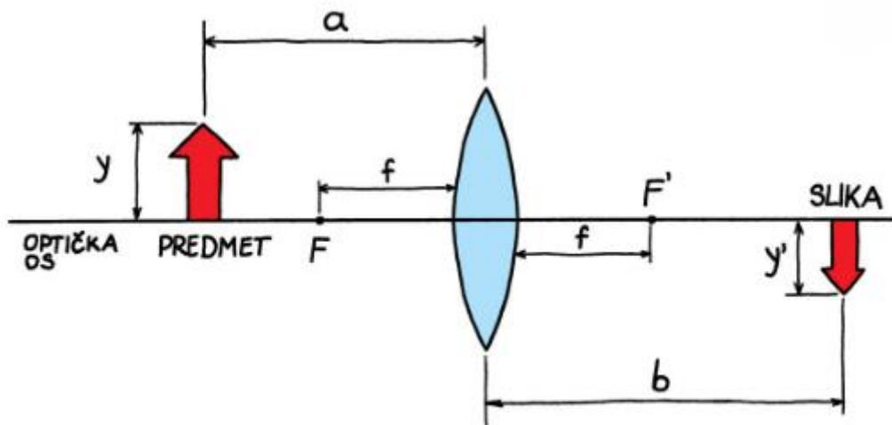
Slika 4. Osnovne optičke karakteristike leće. Preuzeto iz 7.
