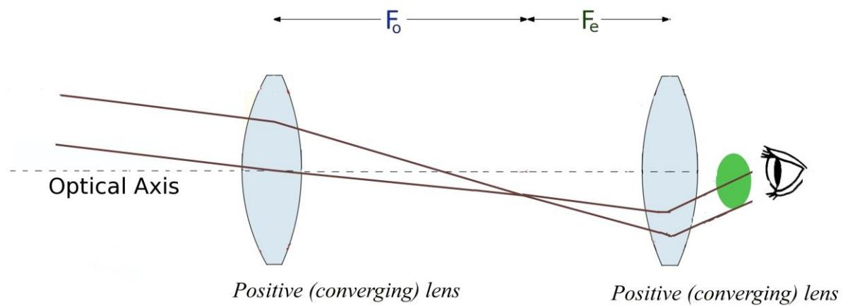
Slika 8. Princip rada lupa - Keplerov tip. Preuzeto iz 2.
