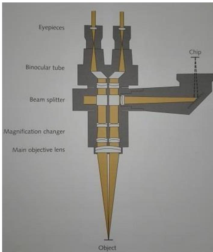
Slika 9. Shema rada operacijskog mikroskopa. Preuzeto iz 8.
