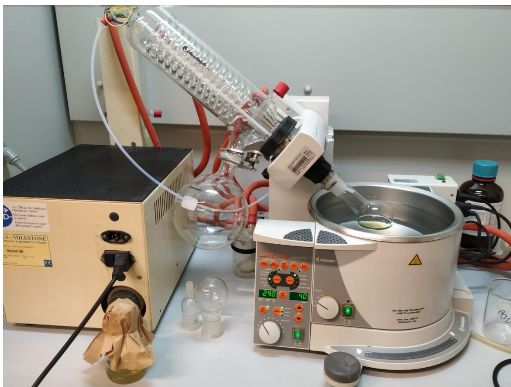
Slika 8. Ekstrakti na isušivanju u rotacijskom vakuumskom uparivaču
