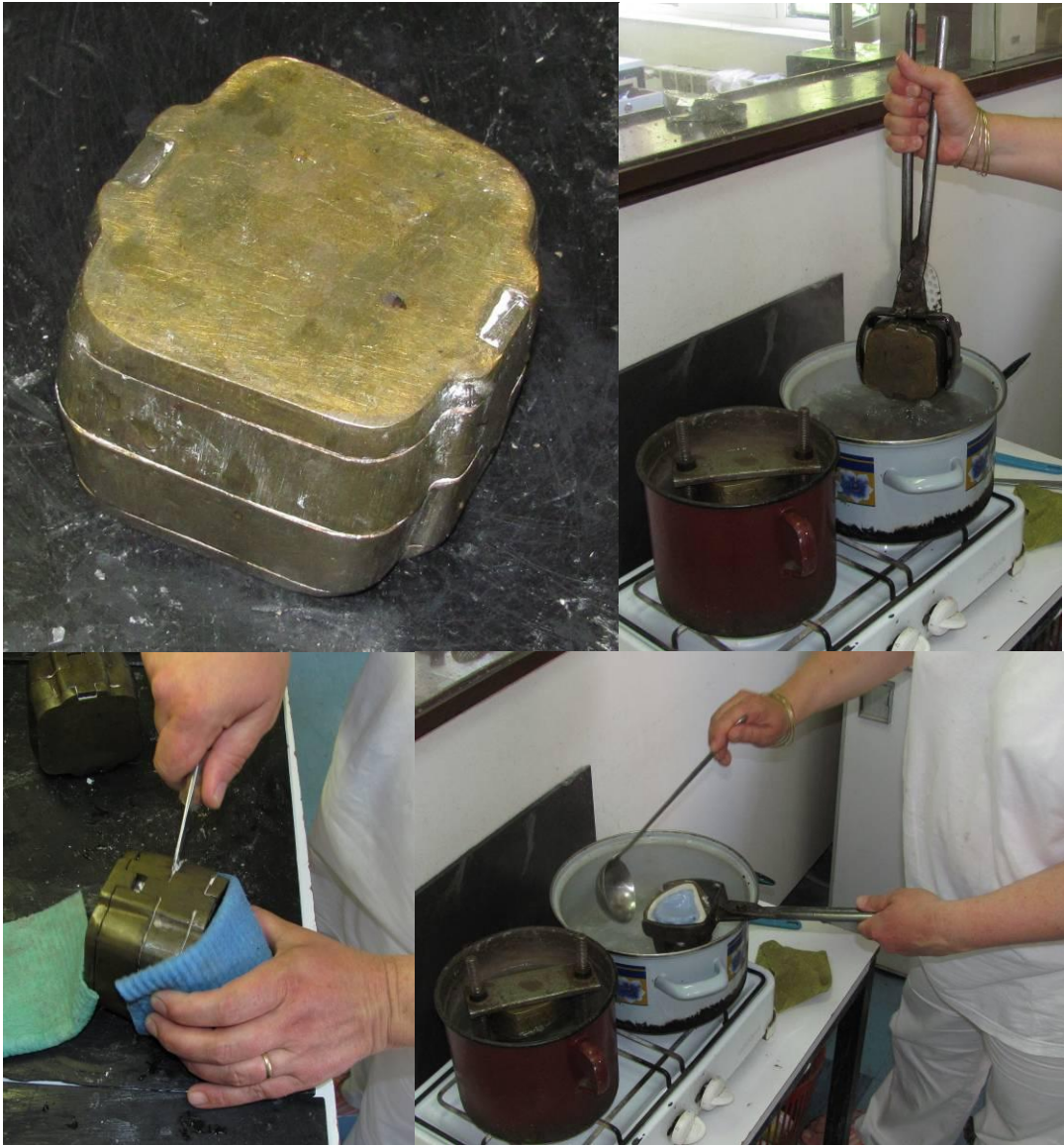
Slike 102 – 105. Kivetiranje naprave izrađene u vosku, otapanje voska kuhanjem, otvaranje kivete i ispiranje otopljenog voska
