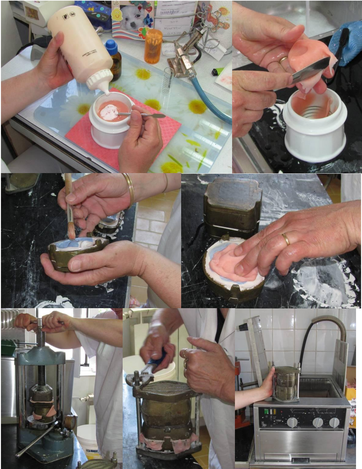
Slike 106 – 112. Priprava akrilatnog tijesta, izolacija kivete, unos akrilata, prešanje i toplinska polimerizacija
