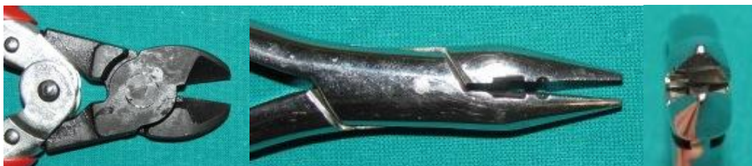
Slike 35 – 37. Kliješta za rezanje žice i savijanje kapljičastih kvačica
