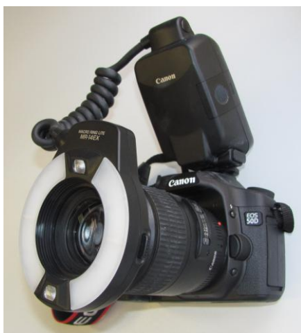
Slika 361. Digitalni fotoaparat s prstenastom bljeskalicom
