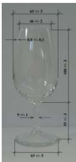
Slika 4.2. Čaša za senzorsku analizu vina (dimenzije u mm)
