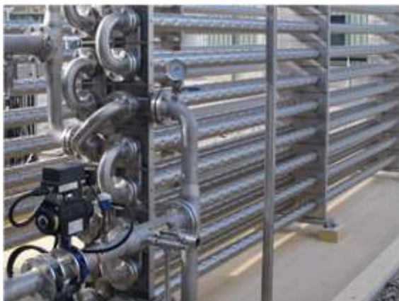
Slika 6.9. Izgled cjevastog izmjenjivača topline u industrijskoj izvedbi (9)
