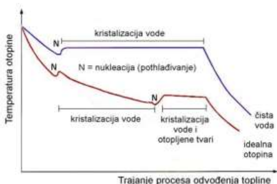
Slika 6.11. Promjena temperature otopine u ovisnosti o vremenu izloženosti rashladnom sredstvu u procesu zamrzavanja (preuređeno prema 5)
