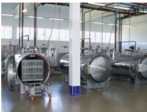
Slika 6.4. Izgled industrijskih autoklava (6)
