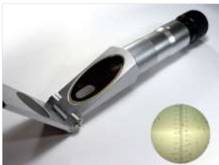
Slika 3.8. Ručni refraktometar za mjerenje udjela šećera u voću ( 22 )
