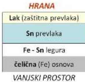
Slika 6.5. Prikaz slojeva na poprečnom presjeku bijelog lima (prema Z )
