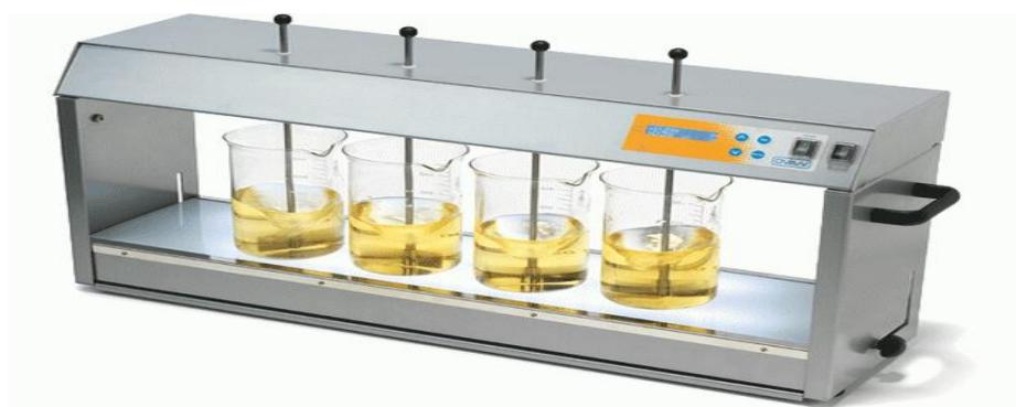
Slika 5. Prikaz uređaja za JAR test
