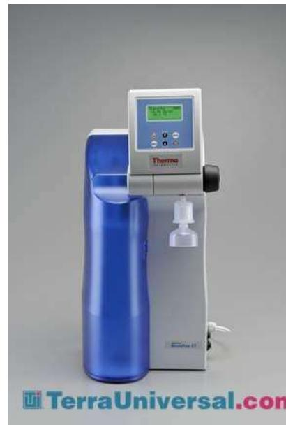
Slika 7. Uredaj za dobivanje super čiste vode, TKA-MicroPure, Njemačka
