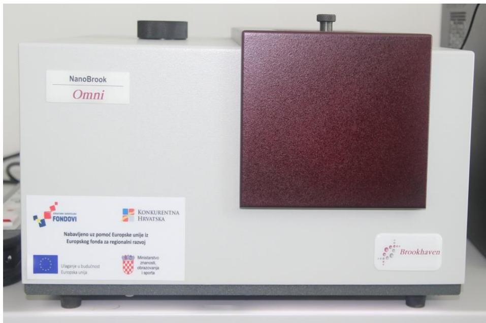
**Slika 9.** Instrument za mjerjenje dinamičkog raspršenja svjetlosti Brookhaven NanoBrook Omni u Laboratoriju za koloide, polielektrolite i međupovršine pri Centru za mikro- i nanoznanosti i tehnologije Sveučilišta u Rijeci.
