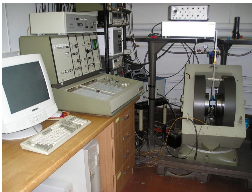
Slika 7. Spektrometar za elektronsku spinsku rezonanciju u Laboratoriju za magnetske rezonancije Instituta „Ruđer Bošković“ u Zagrebu.
