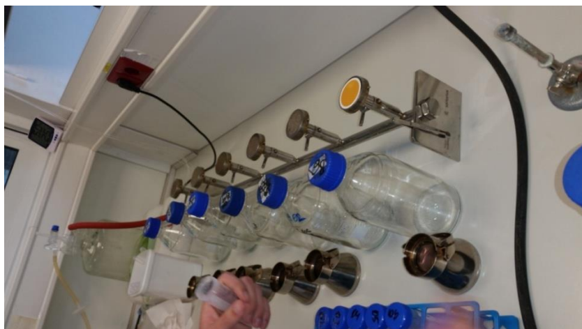
Slika 9. Uklanjanje filter papira nakon membranske filtracije (Fotografirala: Snježana Šimeg, 27.04.2017.)
