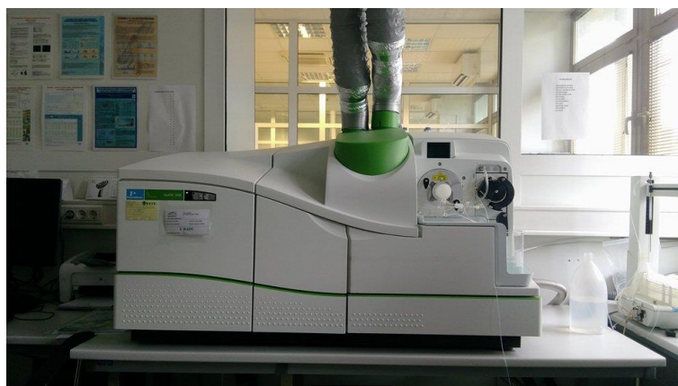
Slika 4. ICP-MS NexION 300x Perkin Elmer
