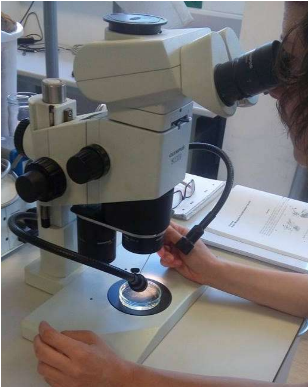
Slika 18. Lupa, Olympus SZX9, povećanja do 100 puta
