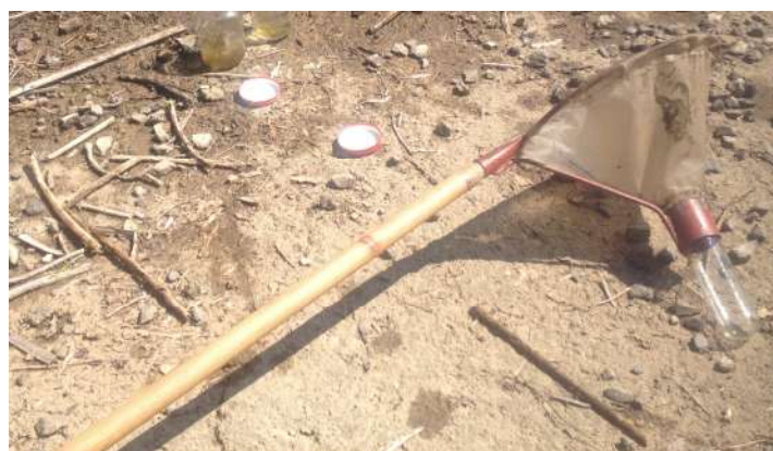
Slika 13. Mrežica – hvataljka (net) promjera 10 ili 25 cm te mala posudica (dipper) za uzorkovanje ličinki [72]
