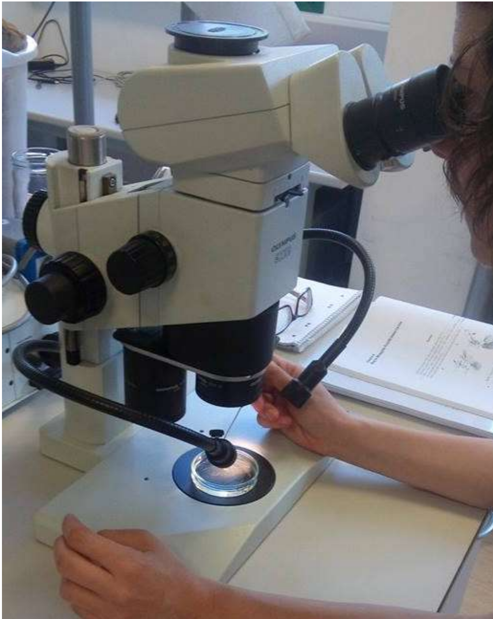
Slika 18. Lupa, Olympus SZX9, povećanja do 100 puta
