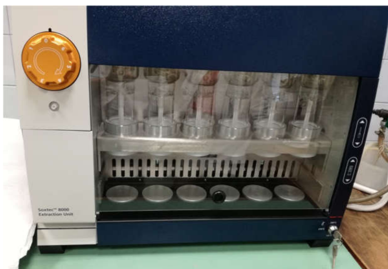
Slika 8. Uređaj za ekstrakciju Soxtec 8000 Extraction unit
