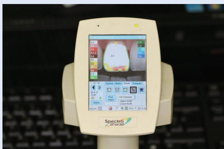
Slika 3. Vizualni prikaz rezultata mjerjenja boje zuba SpectroShade Micro spektrofotometrom
