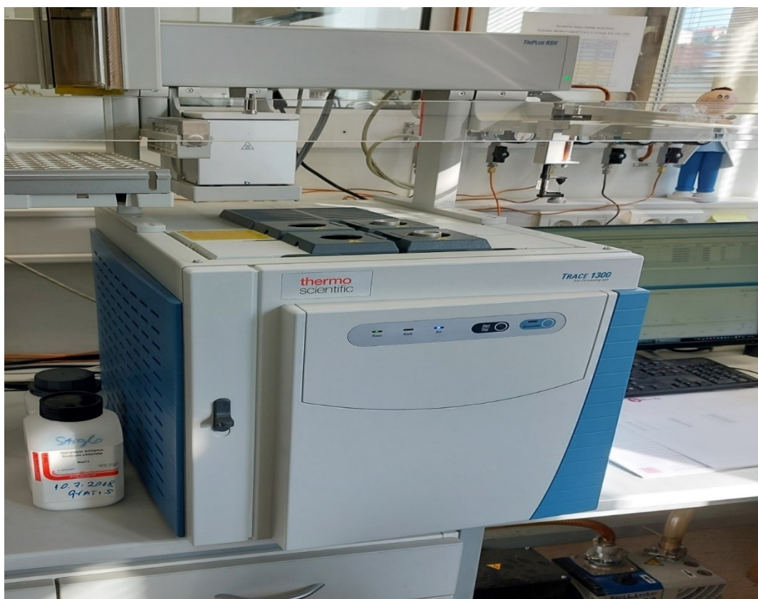
Slika 9. Plinski kromatograf Thermo Trace 1300 GC s FID detektorom, Izvor: osobna arhiva
