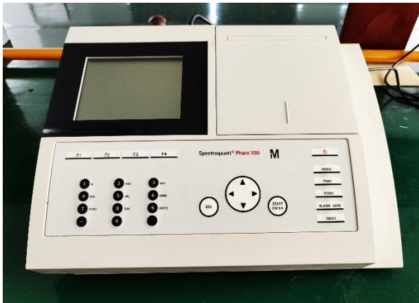
Slika 7. VIS spektrofotometar Spectroquant Pharo 100.
