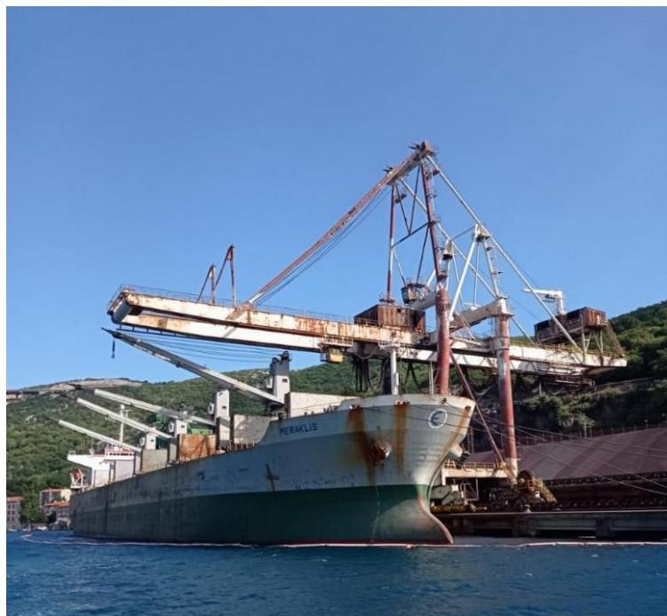
Slika 6. Prekrcaj rasutog tereta u terminalu luke za rasute terete
