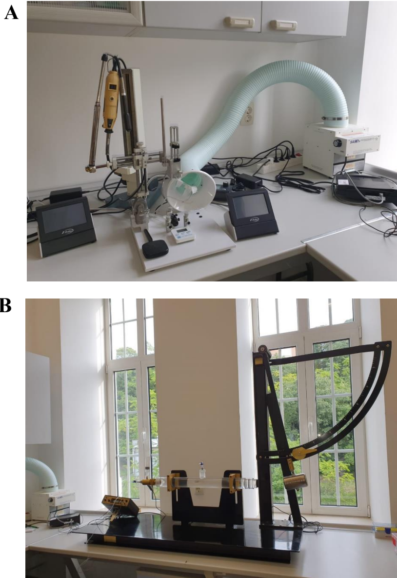
Slika 3. Sustav za eksperimentalnu traumatsku ozljedu mozga. (A) uređaj za stereotaksiju sa sustavom za inhalacijsku anesteziju i automatiziranim injektorom te bušilica; (B) aparat za lateralnu ozljedu tlakom tekućine s pretvaračem signala i osciloskopom.
