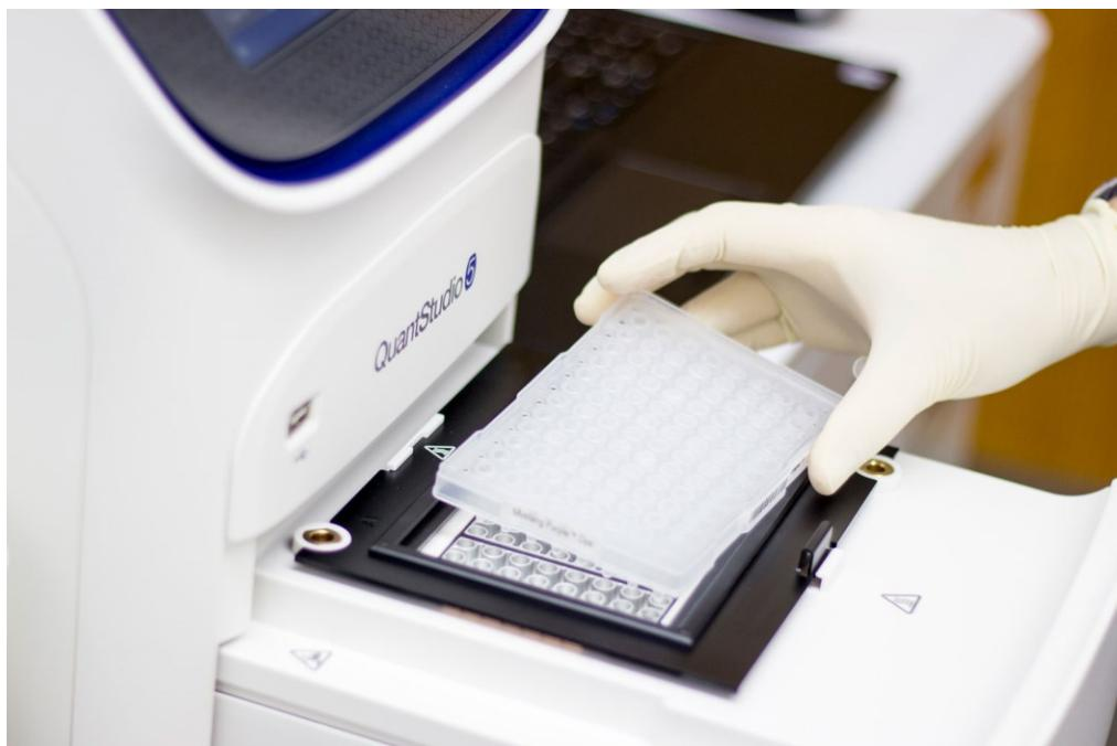
Slika 11 - Postavljanje pločice u qPCR uređaj
