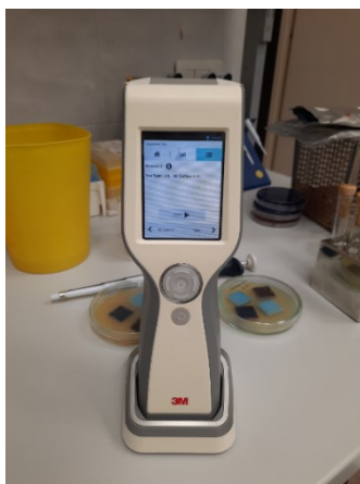
Slika 23. 3M Clean-Trace™ luminometar. Izvor: autor.
