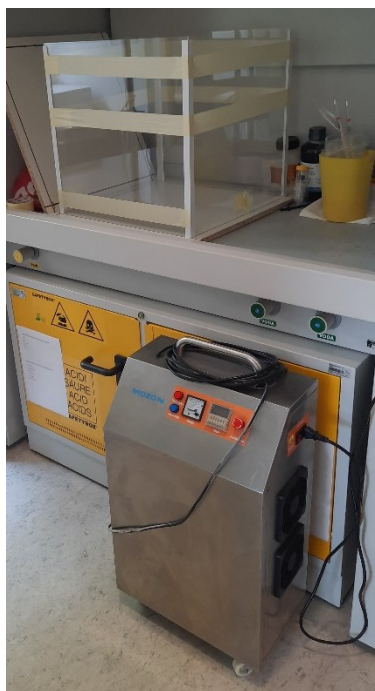
Slika 21. Generator ozona i kutija za ozonizaciju. Izvor: autor.
