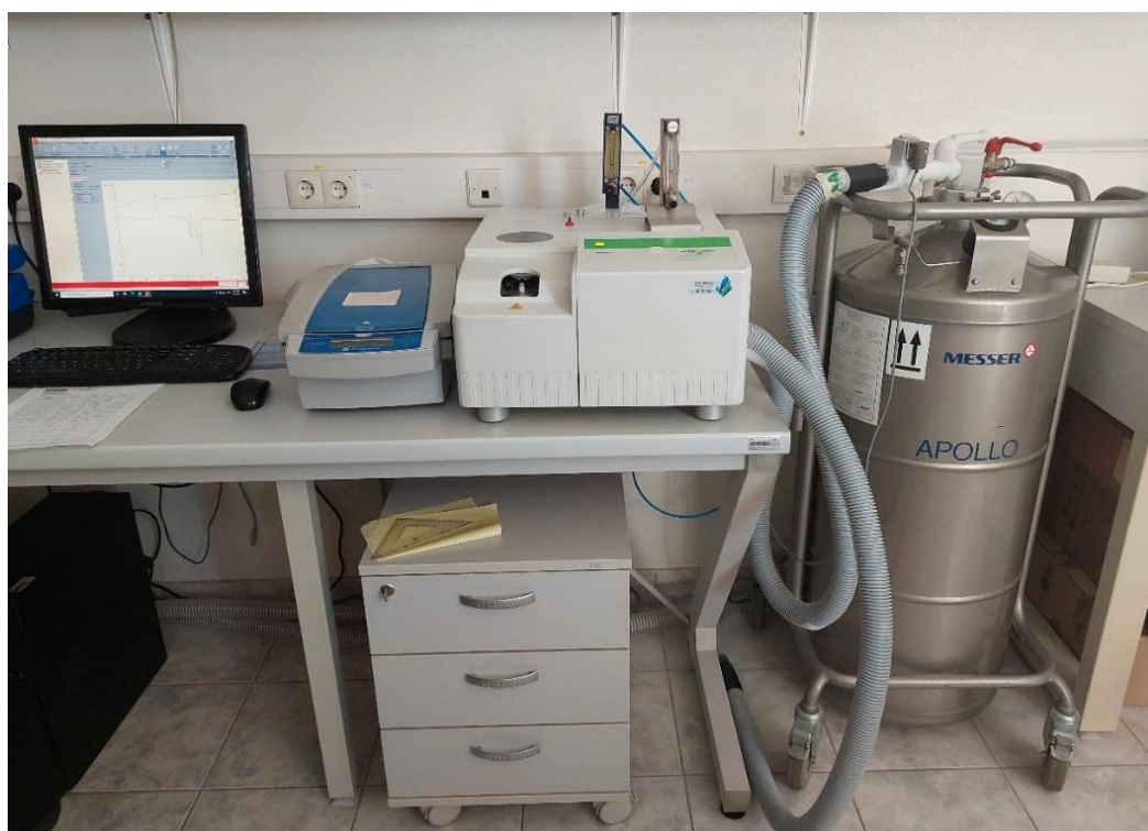
Slika 15. Razlikovni pretražni kalorimetar Mettler Toledo 822e s popratnom opremom.
