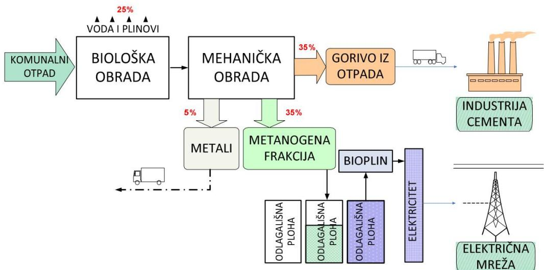
Slika 6. Postrojenje za MBO s biosušenjem i dalnjom obradom biorazgradivog dijela otpada u kontroliranim bioreaktivnim odlagališnim plohamama
