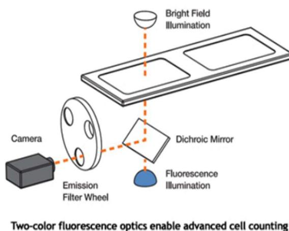
Slika 2. Shematski prikaz funkciranja dvobojne fluorescentne mikroskopske optike koja doprinosi izvrsnoj točnosti brojanja stanica.
