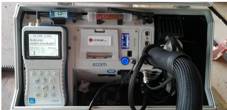
Slika 10. Analizator dimnih plinova RBR-ECOM J2KNpro
