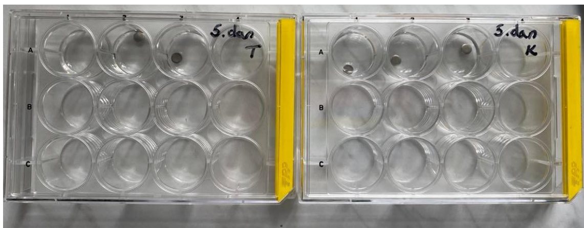
Slika 9. Metalne pločice uronjene u 1mL bakterijske suspenzije unutar jažica 12-titarske pločice
