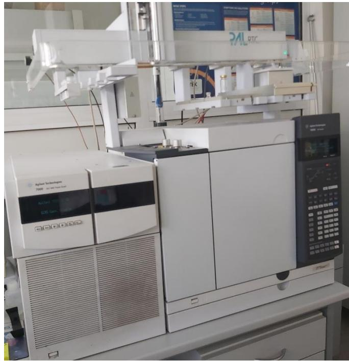
Slika 2. „GC-MS/MS Agilent 7000, GC/MS triple quad, GC 7890b“
