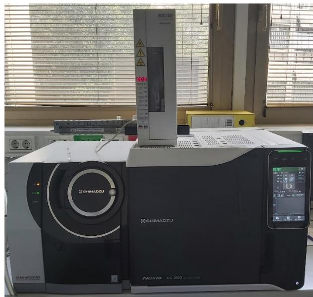
Slika 3. „GC-MS Shimadzu, GCMS-qp 2020 nx, GC GC-2030 nexion“; Izvor: iz osobne arhive
