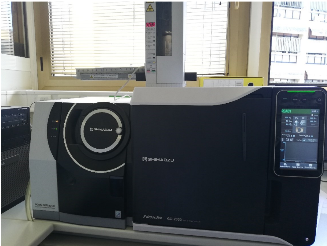
Slika 11. GC-MS Shimadzu GC/MS-QP 2020 NX, Nexis GC 2030
