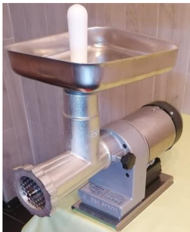
Slika 2. Automatska mašina za mljevenje mesa
