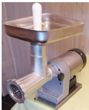
Slika 2. Automatska mašina za mljevenje mesa
