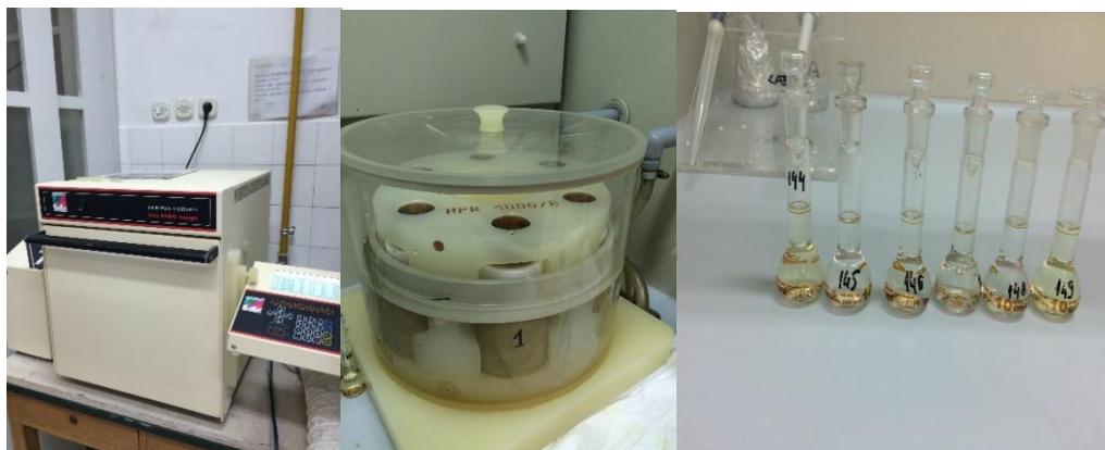
Slika 5. lijevo – uređaj za mikrovalnu digestiju; sredina – postupak hlađenja nakon mikrovalne digestije; desno – razrijeđeni uzorci
