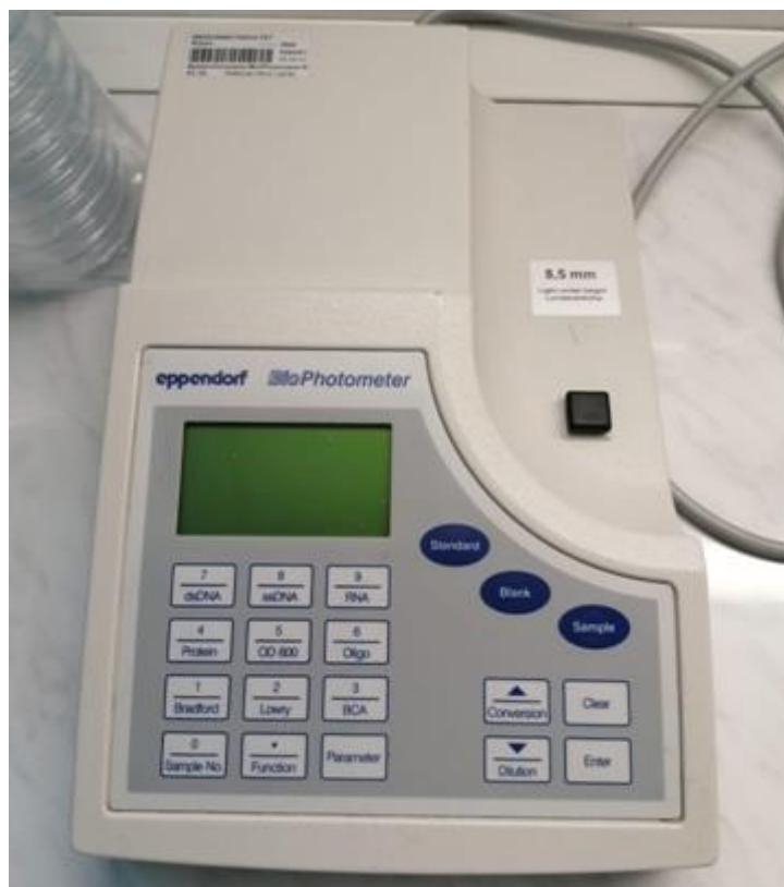
Slika 6. UV-VIS eppendorf BioPhotometer (Fotografija: Luka Devčić)
