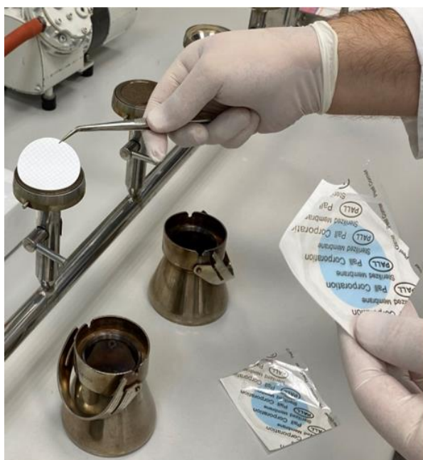
Slika 3. Postavljanje sterilnog filtra na aparaturu
