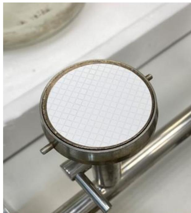
**Slika 2.** Prikaz sterilnog filtera
