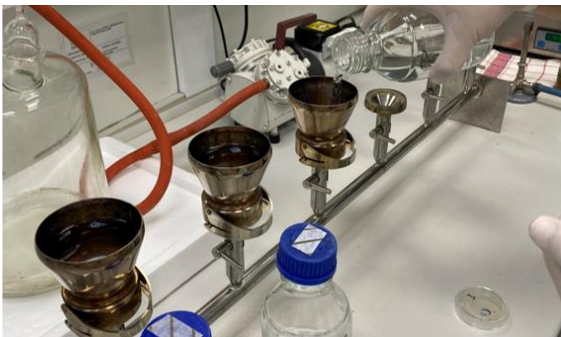
Slika 4. Filtriranje 100 mL uzorka preko sterilnog filtra
