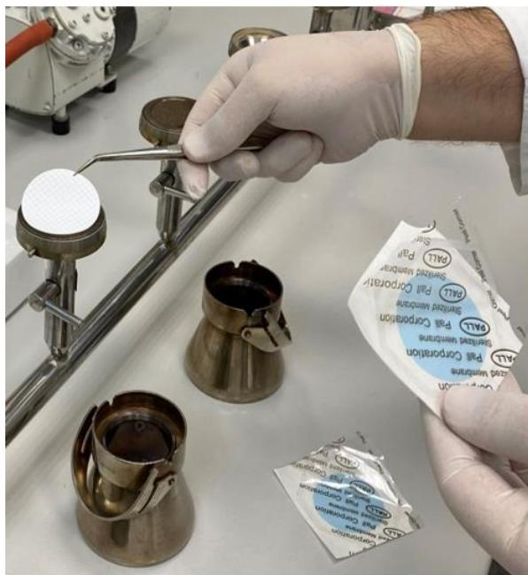
Slika 3. Postavljanje sterilnog filtra na aparatu
