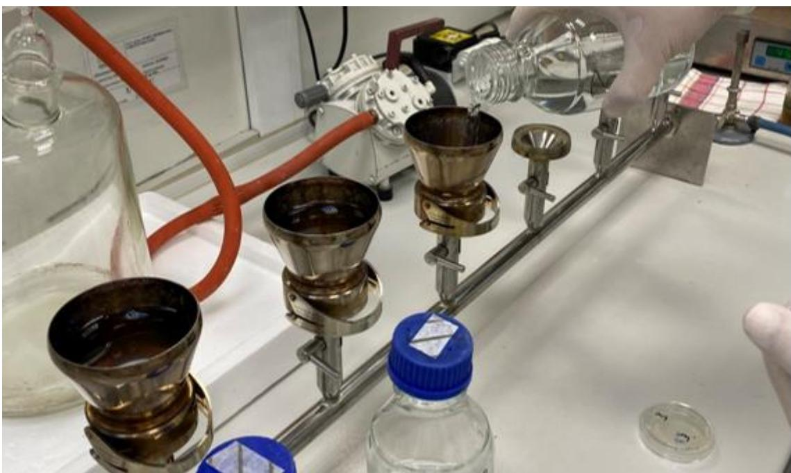
Slika 4. Filtriranje 100 mL uzorka preko sterilnog filtera
