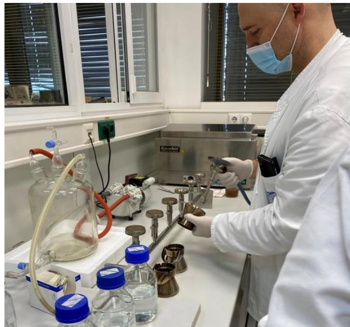
**Slika 1.** Postupak provođenja sterilizacije aparature pomoću plamena
