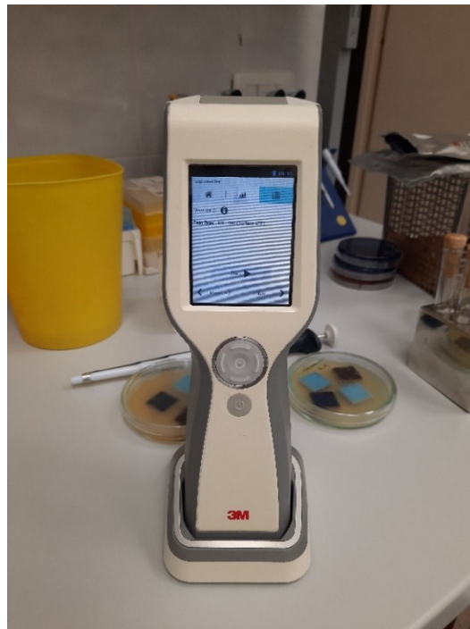
Slika 5. 3M Clean-Trace™ uređaj za očitavanje brzog ATP Surface testa - luminometar
