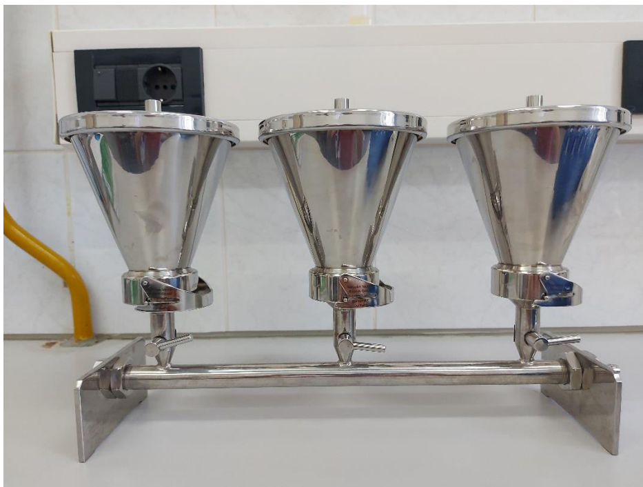
Slika 9. Sustav za membransku filtraciju (Izvor: Autor)
