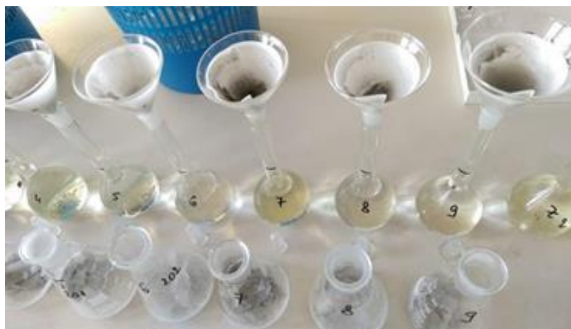
Slika 9. Filtracija ekstrahiranih uzoraka
