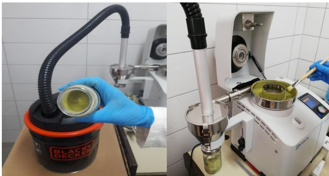
Slika 9. Centrifugalni mlin za mljevenje uzoraka maslinovog lišća.
