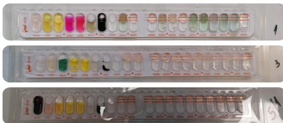
Slika 13. Prikaz API testa za P. aeruginosa (gore), API testa za P. putida (sredina) i API testa za V. parahaemolyticus (dolje)
