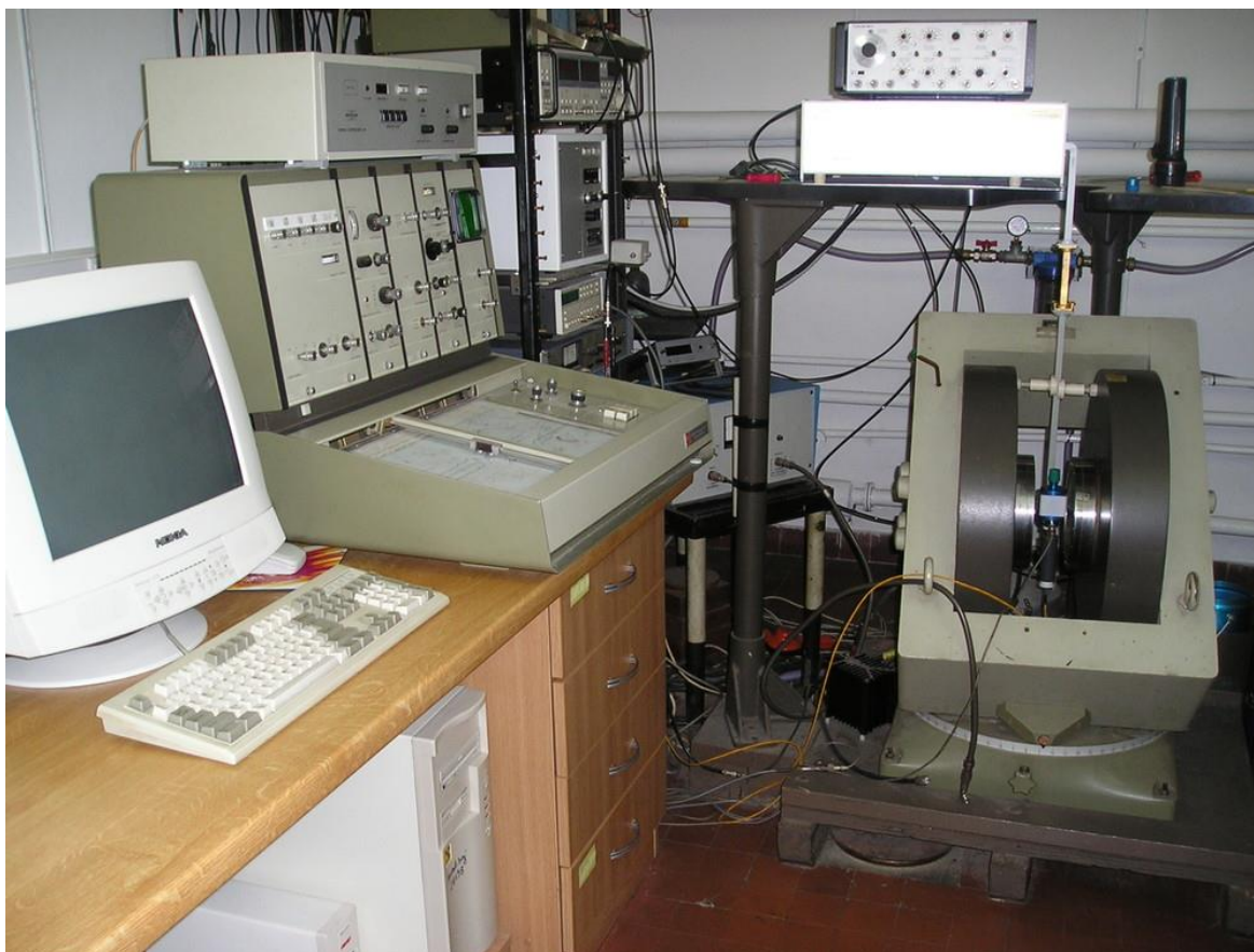
Slika 14. Spektrometar za elektronsku spinsku rezonanciju u Laboratoriju za magnetske rezonancije Instituta Ruđer Bošković u Zagrebu.
