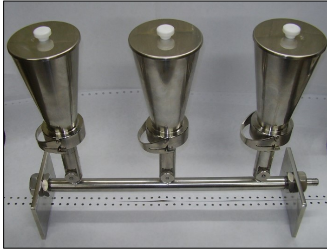
Slika 26. Uređaj za membransku filtraciju (izvor : Inkolab. Dostupno na : http://inko.hr/ )
