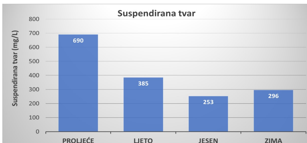
Slika 11. Koncentracija suspendirane tvari na ulazu u kontinentalni uređaj po sezonama
