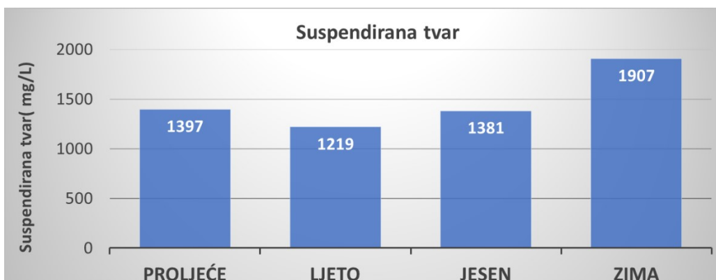
Slika 16. Koncentracija suspendirane tvari na ulazu u primorski uređaj po sezonama
