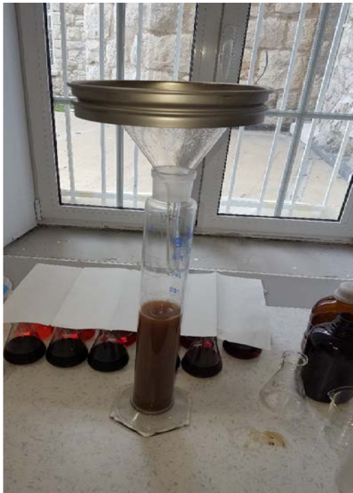
Slika 4. Prosijavanje uzoraka tla kroz 0,2 mm sito u Novakov cilindar
