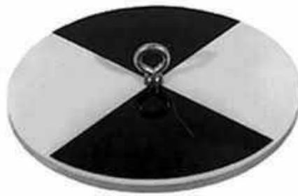
Slika 3. Secchi disk za mjerenje turbiditeta [19]
