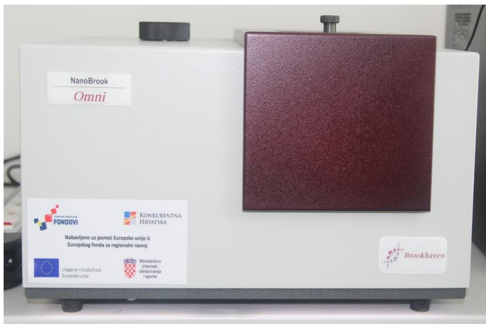
Slika 9. Instrument za mjerenje dinamičkog raspršenja svjetlosti Brookhaven NanoBrook Omni u Laboratoriju za koloide, polielektrolite i međupovršine pri Centru za mikro- i nanoznanosti i tehnologije Sveučilišta u Rijeci.
