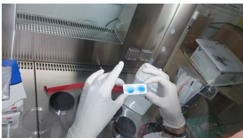
Slika 32. Rotacija DrySpot testa do 60 sekundi (Fotografirala: Snježana Šimeg, 28.04.2017.)
