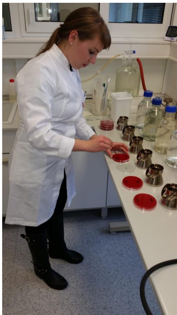
Slika 7. Razmaz 1 mL uzorka bazenske vode na krvni agar (KA) (Fotografirala: Snježana Šimeg, 27.04.2017.)
