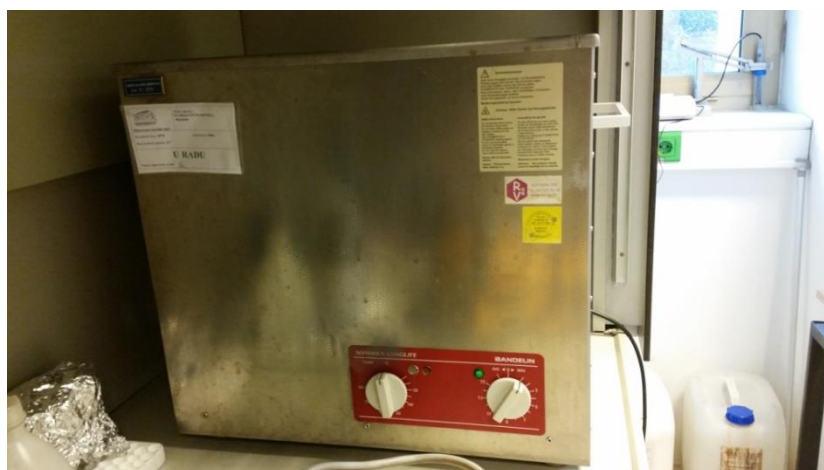
Slika 11. Ultrazvučna kupelj (Fotografirala: Snježana Šimeg, 27.04.2017.)
