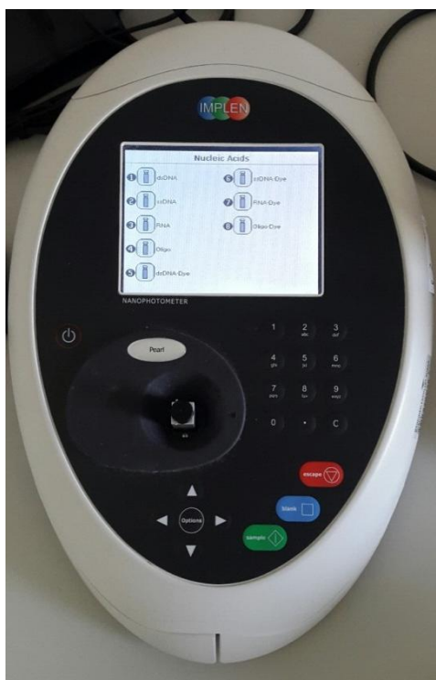
Slika 2. Implen NanoPhotometer™ Pearl
