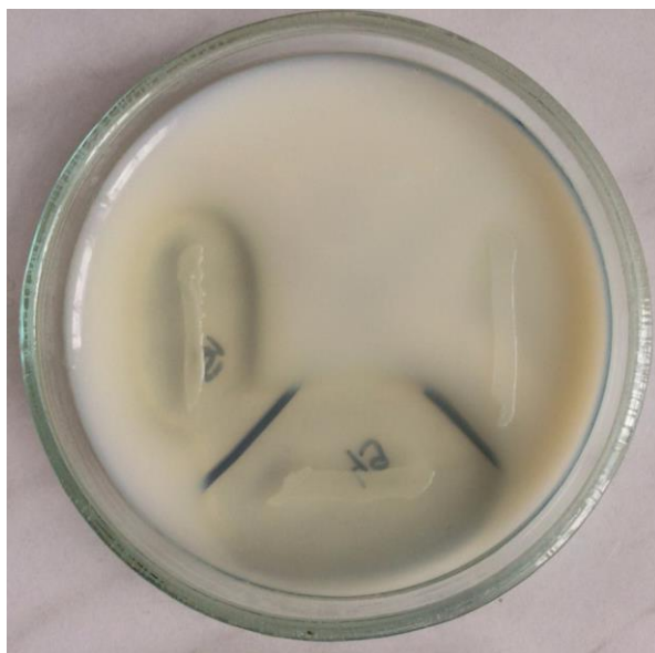
Slika 6. Metoda određivanja enzima proteaze na Skim milk agaru
