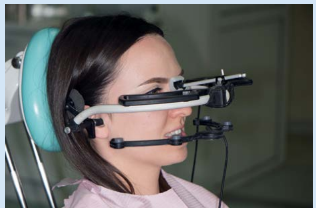
Slika 2. Ultrazvučni uređaj za snimanje kretanja donje čeljusti na temelju šest stupnjeva slobode
