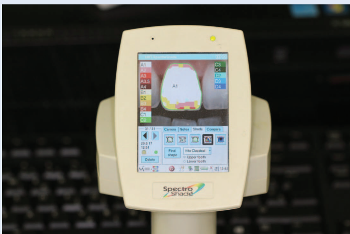
Slika 3. Vizualni prikaz rezultata mjerenja boje zuba SpectroShade Micro spektrofotometrom
